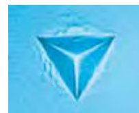
使用三棱锥压头产生的压痕
